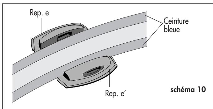
Attention : l'ensemble rep. 13 a un sens. Il est impératif que la boucle rep. c doit être positionnée conformément au **schéma 11**. Emboîtez la pièce rep. a, axe de liaison afin que celle-ci traverse les pièces e, 13 et e'.
